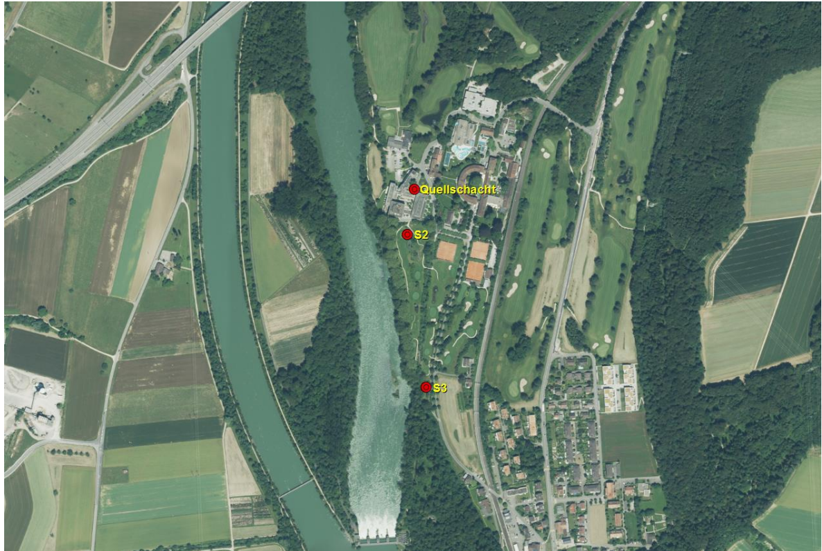
Abbildung 2: Lage der drei Thermalquellen in Schinznach-Bad. Die heutige Nutzung erfolgt aus der Bohrung S3. Die S2 ist 136 m tief und wird nur als Rückgabebohrung verwendet. Der alte 9 m tiefe Quellschacht ist als Schauobjekt noch erhalten.
