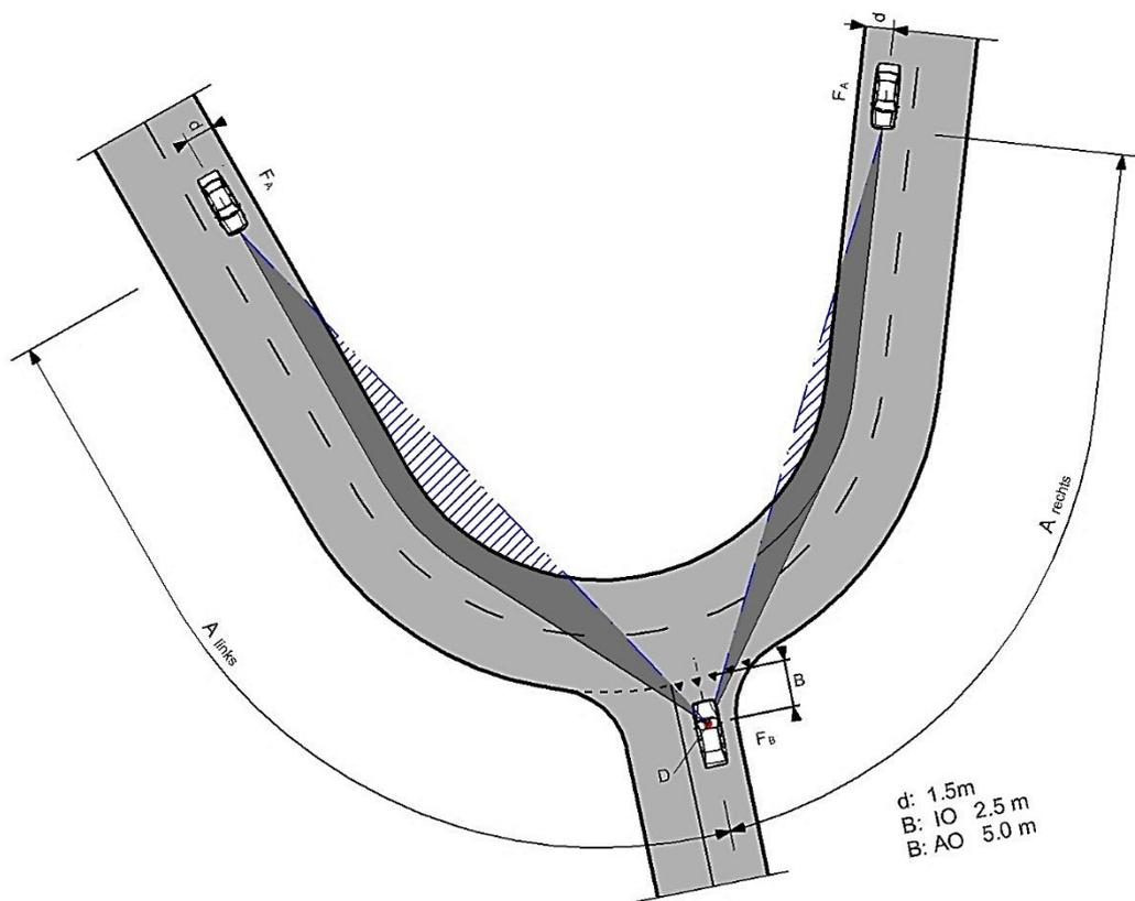
Abbildung 7: Sichtfelder bei Einmündungen in stark gekrümmten Aussenkurven
