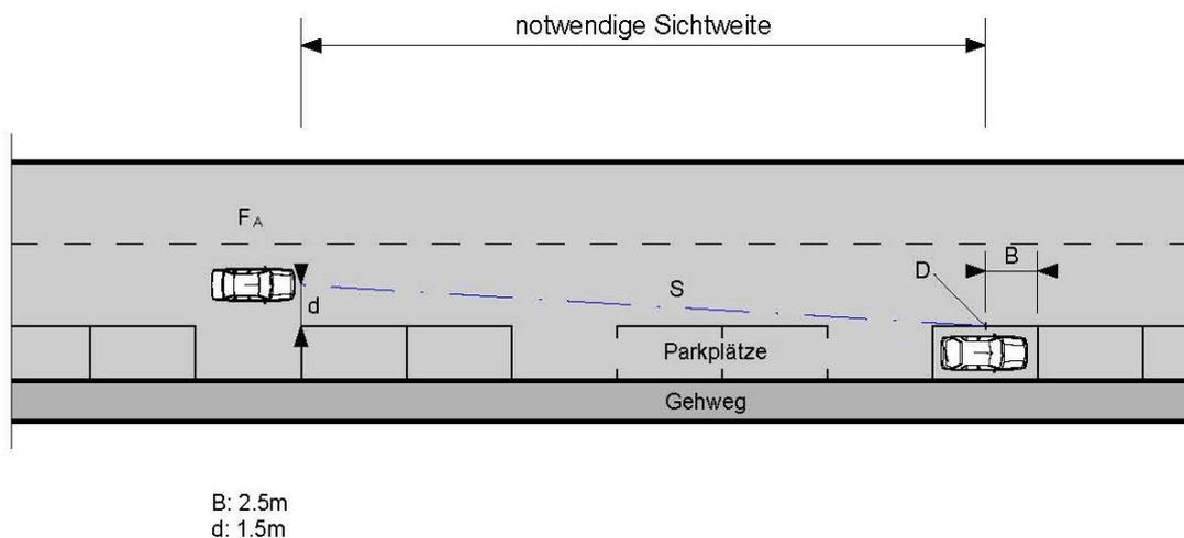
Abbildung 17: Sicht bei der Wegfahrt aus Längsparkplätzen
