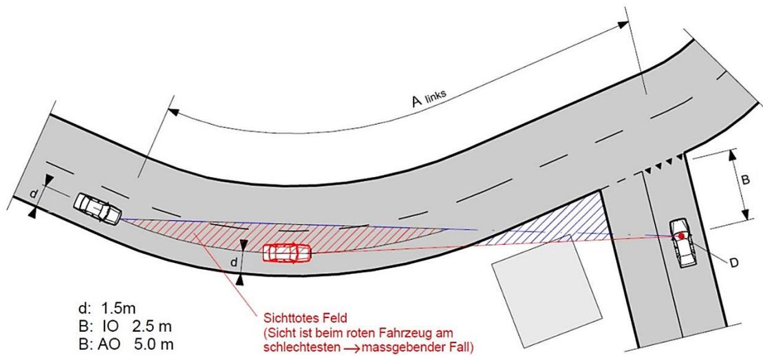
Abbildung 6: Sichttotes Feld bei Knoten in Aussenkurven
