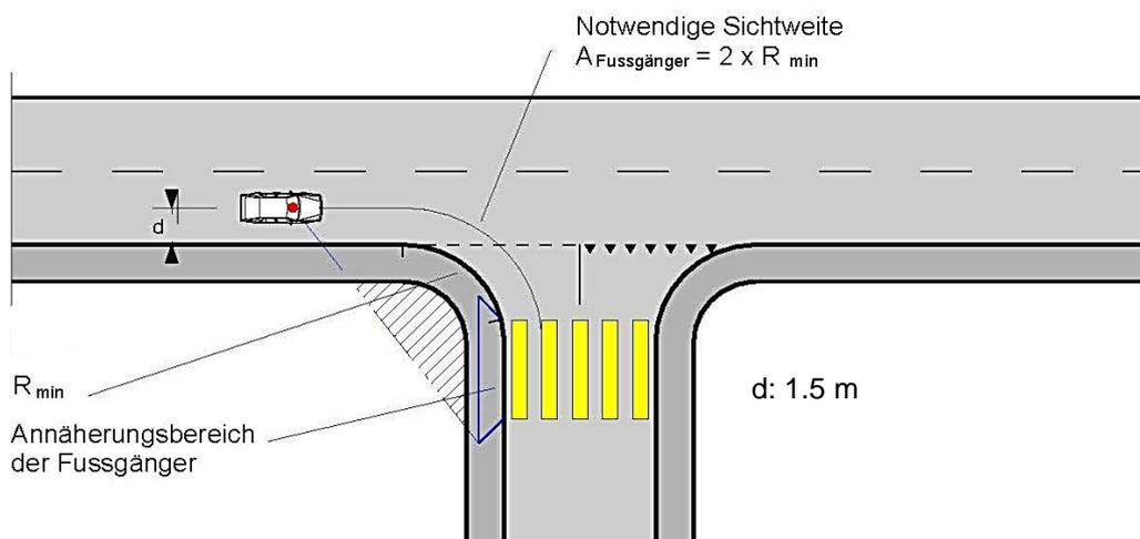
Abbildung 16: Sicht bei Fussgängerquerungsstellen über die Querfahrbahn
