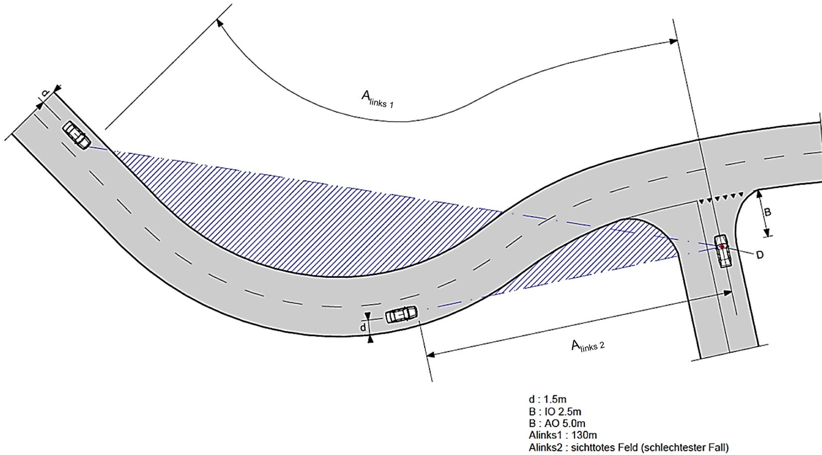
Abbildung 8: Sichtfelder bei Einmündungen auf kurvigen Strecken
