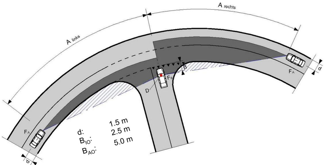
Abbildung 5: Sichtverhältnisse an Knoten in Innenkurven
