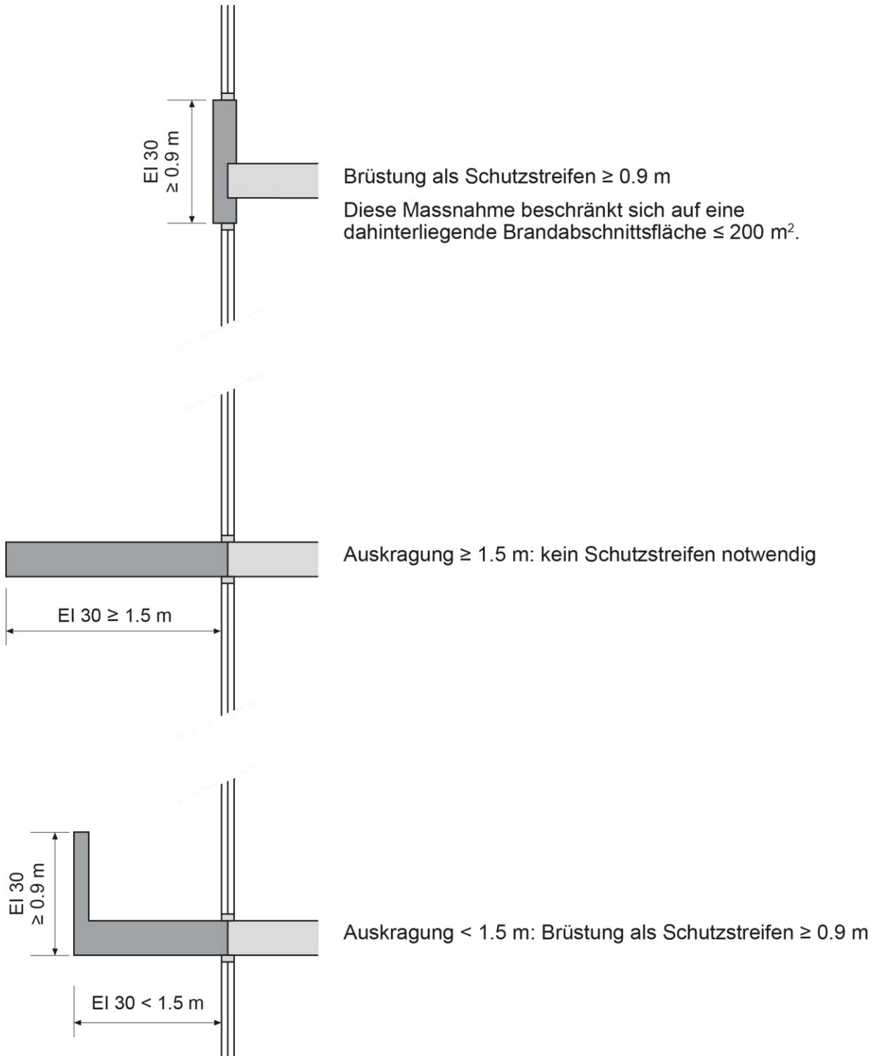
Massnahmen mit Löschanlagenkonzept.
