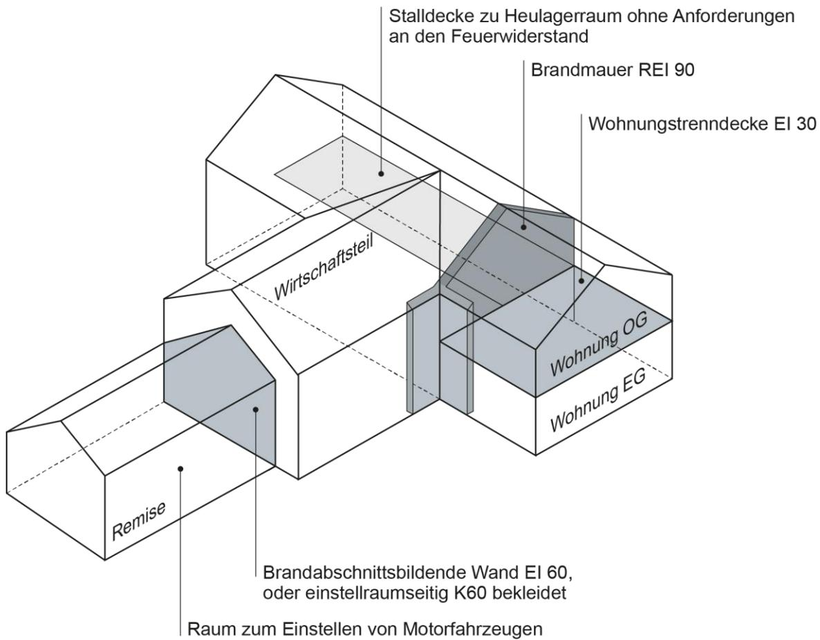
Bezüglich Brandschutzanforderungen für Brandmauern wird verwiesen auf die Bestimmungen der Brandschutzerläuterung „Brandmauern“.
