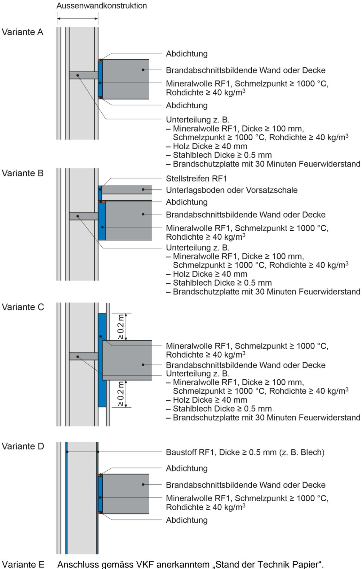
**Anschlüsse von brandabschnittsbildenden Bauteilen an Bedachungen (Ziffer 3.3.3, Abs. 2)**
