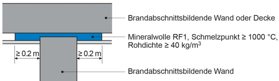
Variante C Verwendung von VKF anerkannten Fugenabdichtungen mit Feuerwiderstand.
